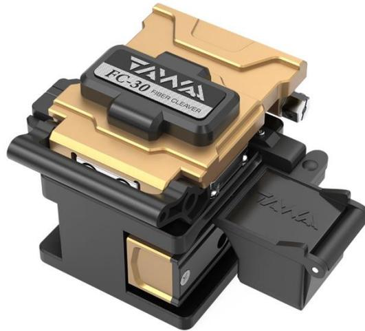
TAWAA FC-30 es una cuchilla de banco tradicional, simple y fácil de usar. Está disponible con un colector fuera de línea de fibra. Es aplicable a 250µm. Cable de fibra de 900µm, 3,0mm y cable plano. Eficiencia de trabajo y ángulo escotado de alta precisión de 0,5 grados típicos. La hoja proporciona más de 48.000 hendiduras de fibra mediante una selección fácil y sencilla de la posición de la hoja.
